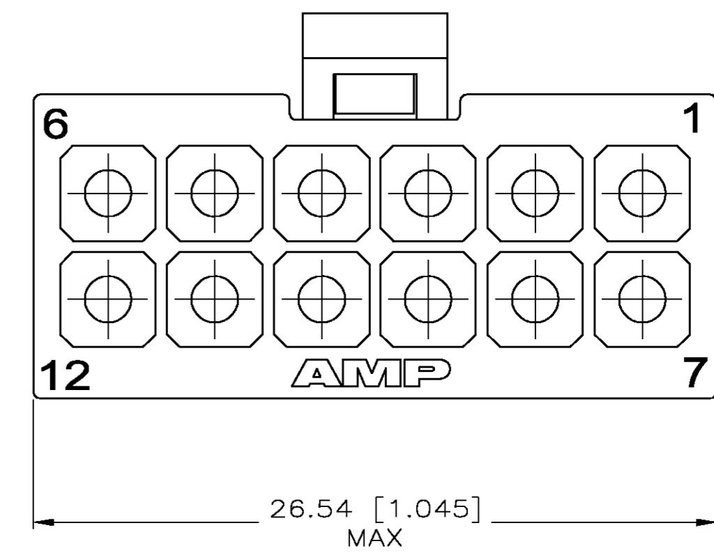
1. 150°C TEMPERATURE RATING FOR THIS HOUSING IS FOR SHORT TERM DURATION ONLY. MAXIMUM OPERATING TEMPERATURE REMAINS 105°C.
