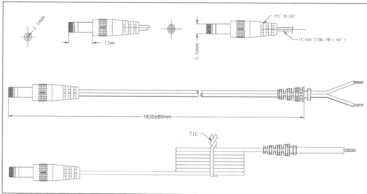
1 DC Plug:  $5.5\pm0.05\text{mm}$  \*  $2.1\pm0.05\text{mm}$  \*  $12\pm0.5\text{mm}$  \*  $\ominus$   $\odot$   $\oplus$
