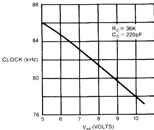
TYPICAL CLOCK VERSUS  $V_{dd}$  @  $25^\circ C$
