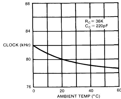
TYPICAL CLOCK VERSUS TEMPERATURE FOR  $V_{dd} = 9$  VOLTS
