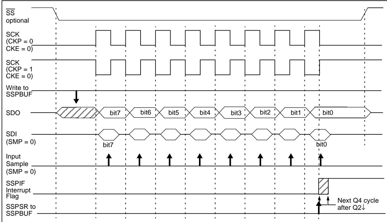
**FIGURE 9-6: SPI MODE WAVEFORM (SLAVE MODE WITH CKE = 1)**
